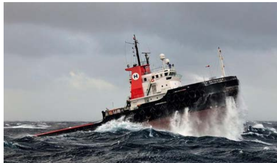
Retriever: Lengte 61.46 M Breedte 15.30 M Diepgang 7.04 M 2 x Krupp 16 cilinder 4 takt 5996 HP
